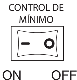
Figura 18 - Interruptor de control de Idle (espera)
