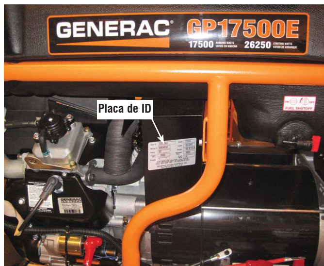
Figura 1 - Paca de ID del generador
