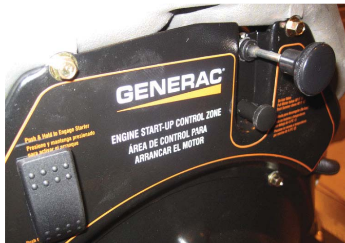
Schéma 19 - Position d'étrangleur plein
