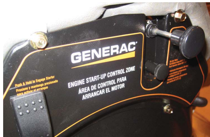
Figura 19 - Posición Full Choke
