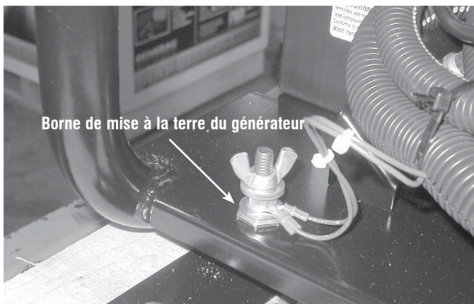
Schéma 15 - Mise à la terre du générateur
